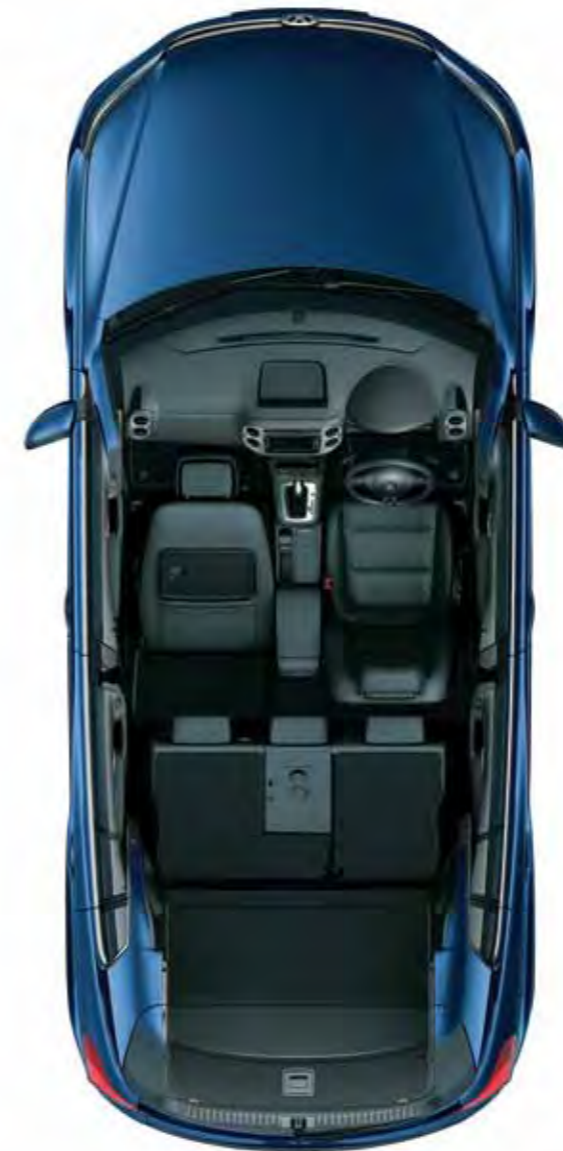
後席は、背もたれを倒すと連動して座面が沈み込むシングルフォールディング式を採用。手軽に広大なラゲージスペースを作り出せます。
