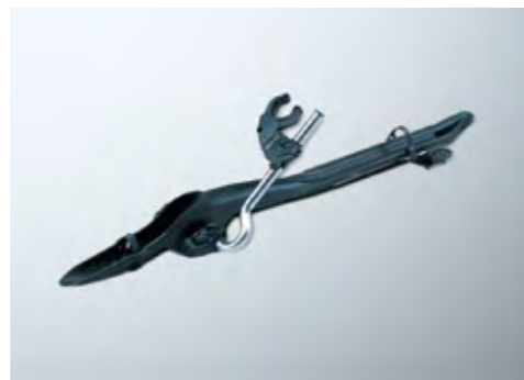
08 バイシクルホルダー :自転車のダウンチューブとホイールを固定して積載するアタッチメントです。 ※ダウンチューブ径80φ、タイヤ幅56mm、ホイールリム高さ90mm(タイヤを含む)まで対応。※装着には、キャリングロッドが必要です。
