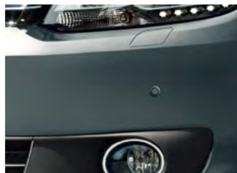
10 コーナーセンサー(フロント) :フロントバンパー左右のセンサーで、約60cm以内の障害物を感知。4段階の警告ブザーで注意を促します。 ※写真のセンサーはボディ同色に塗装済み(別途、塗装代が必要となります)。
