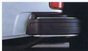
アルミ仕上の排気パイプ
