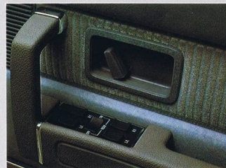
1. パワーウインドウのスイッチはドライバーのアームレスト内に設置され、操作が簡単です。
