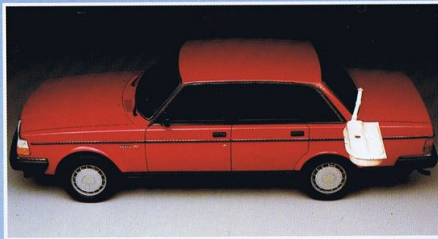
燃料タンクの位置は、万一、後から衝突されても燃料もれて炎上したりしないように、リアアクスルとケージ構造部の間にあります。
