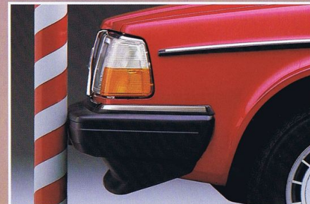
時速4kmで衝突した時の衝撃を吸収するバンパー。
