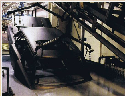
防錆処理のためにボディ全体を洗める電着塗装バス。
