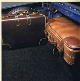
トランクルームは全面カーペット敷き。615ℓの有効スペースをもち、大型のスーツケースでも縦にならべて入れることができます。スペアタイヤは左側に縦位置で収納してありますから、荷物を移動しなくてもタイヤ交換ができます。
