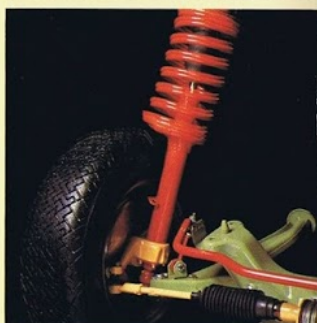
フロントサスペンションはスプリングストラットを採用。路面のショックを吸収し、快適な乗心地をお約束します。
