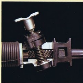
ラックアンドピニオンのステアリング機構。確実なレスポンスと方向安定性を、実際にお乗りになってお確かめください。
