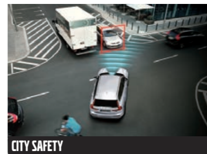
CITY SAFETY インターセクション・サポート (右折時対向車検知機能)
