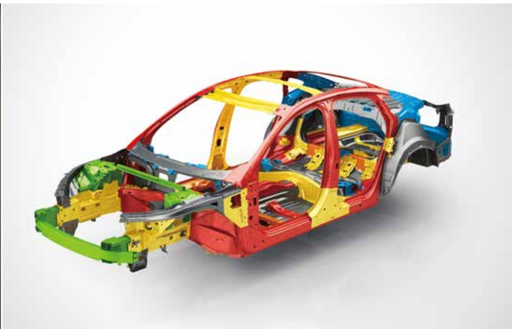
強度の異なる数種類のスチールを組み合わせた衝撃吸収システム構造
