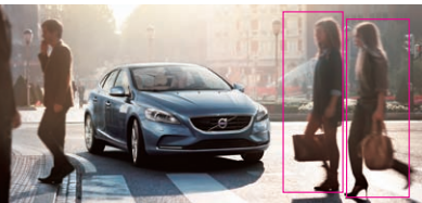
ヒューマン・セーフティ (歩行者・サイクリスト検知機能付追突回避・軽減フルオートブレーキ・システム) 高性能デュアルモード・レーダーセンサー、デジタルカメラと赤外線レーザーセンサーにより、前方の車両やサイクリスト・歩行者を常にモニター。衝突の危険を検知するとドライバーに警告、これに反応せずに衝突の可能性が高まると、自動的にフルブレーキを作動させ、衝突を回避・軽減する最新の安全システム。
