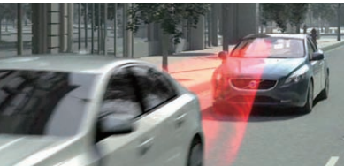
シティ・セーフティ (低速用追突回避・軽減オートブレーキ・システム) 低速時の追突を未然に回避、もしくはダメージを軽減させる先進の安全機能です。前方車両をレーザーセンサーで監視し、追突の危険性を検知するとブレーキが準備態勢に入り、さらにドライバーがブレーキを踏まない場合には自動的にブレーキを作動させます。
