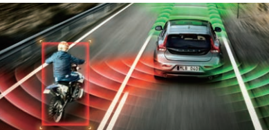
BLIS (ブラインドスポット・インフォメーション・システム) / LCMA (レーン・チェンジ・マージ・エイド) リアバンパーに装着された高精度ミリ波レーダーによって、後方や側面にいる見えない車を監視します。他の車が死角に入っている場合や後方から接近してきた場合に警告でその存在を知らせます。さらに、LCMAが、常に70m後方の道路状況を監視し、警告で急接近する車の存在を知らせます。
