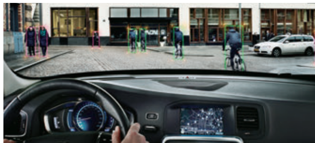
歩行者・サイクリスト検知機能付追突回避・軽減フルオートブレーキ・システム（ミリ波レーダー、デジタルカメラ、赤外線レーザー方式）
