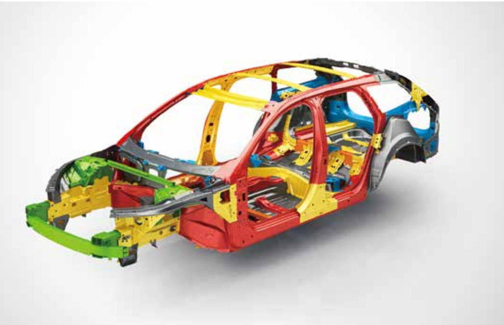
強度の異なる数種類のスチールを組み合わせた衝撃吸収システム構造 ■：MS（マイルドスチール） ■：HSS（ハイレングススチール） ■：VHSS（ベリ－ハイレングススチール） ■：EHSS（エクストラハイレングススチール） ■：UHSS（ウルトラハイレングススチール／ボロンスチール） ■：アルミニウム
