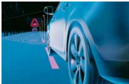
オンカミング・レーン・ミティゲーション (対向車衝突回避支援機能)
