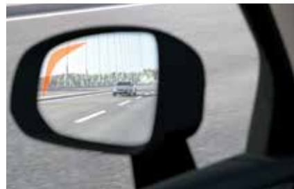
ステアリング・アシスト付BLIS™ (後車衝突回避支援機能付ブラインドスポット・インフォメーション・システム)
