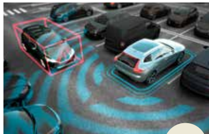
衝突回避・被害軽減ブレーキ機能付 CTA (クロス・トラフィック・アラート)
