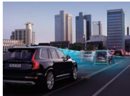
全車速追従機能付ACC (アダプティブ・クルーズ・コントロール)
