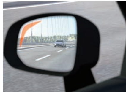
ステアリング・アシスト付BLIS™ (後車衝突回避支援機能付ブラインドスポット・インフォメーション・システム)
