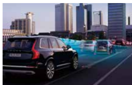
全車速追従機能付ACC (アダプティブ・クルーズ・コントロール)
