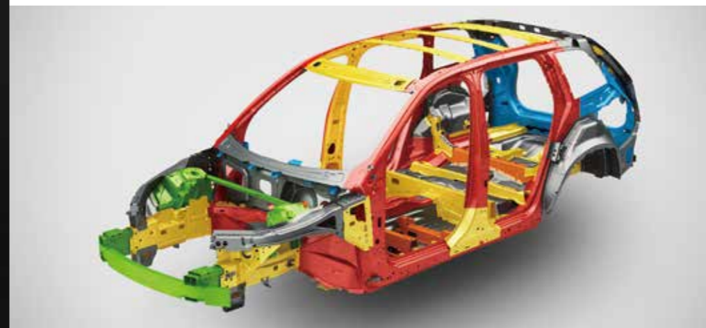
強度の異なる数種類のスチールを組み合わせた衝撃吸収システム構造
