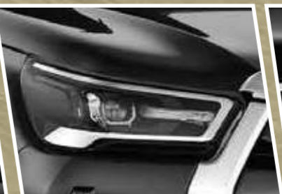
ចង្រៀង Bi-Beam LED Projector ភ្ជាប់ជាមួយ ចង្រៀងកាត់អំពូល LED រចនារូបរាងថ្មីកាន់តែ ទាន់សម័យ
