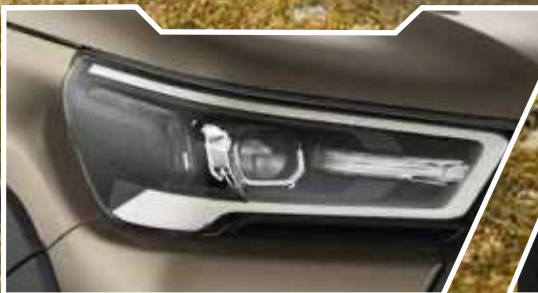
ចង្រៀង Bi-Beam LED Projector ភ្ជាប់ជាមួយ អំពូល Daytime Running Light
