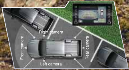
កាមេរ៉ា 360 ដឺរេក បង្ហាញរូបភាពមួយជុំរថយន្ត
