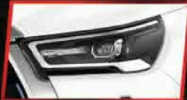
ចង្រ្កើង Bi-Beam LED Projector ភ្ជាប់ជាមួយអំពូល Daytime Running Light
