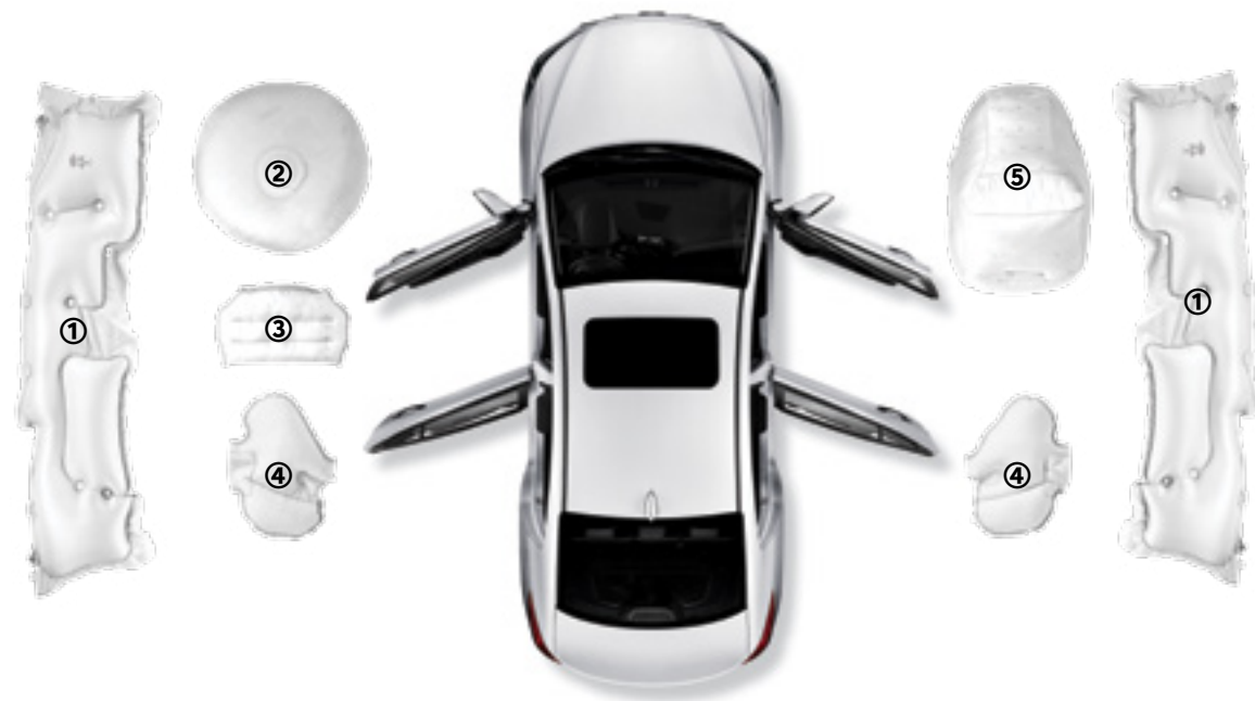
① 전복 대응 커튼 에어백 ② 운전석 에어백 ③ 운전석 무릎 에어백 ④ 앞좌석 사이드 에어백 ⑤ 동승석 에어백
