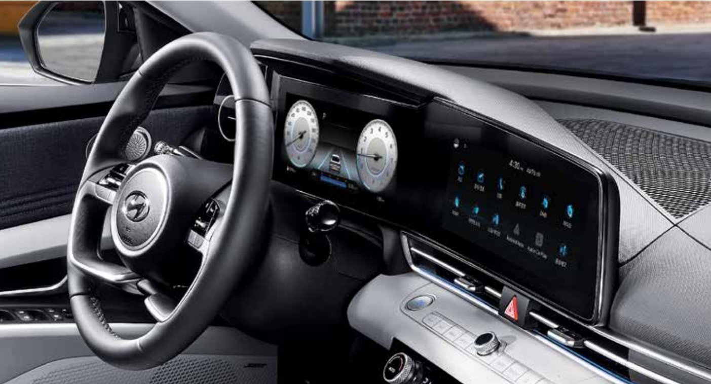
파노라마 디스플레이 10.25인치 풀 컬러 클러스터와 10.25인치 내비게이션이 끊김 없이 이어진 파노라마 디스플레이는 운전자 쪽으로 10도 기울어져 편리한 조작감과 하이테크한 감성을 전달합니다.
