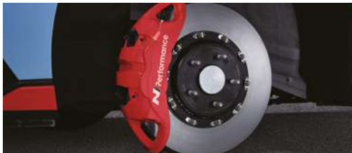
N 퍼포먼스 브레이크 시스템 (모노블록 4피스톤 캘리퍼, 볼팅타입 하이브리드 디스크)
