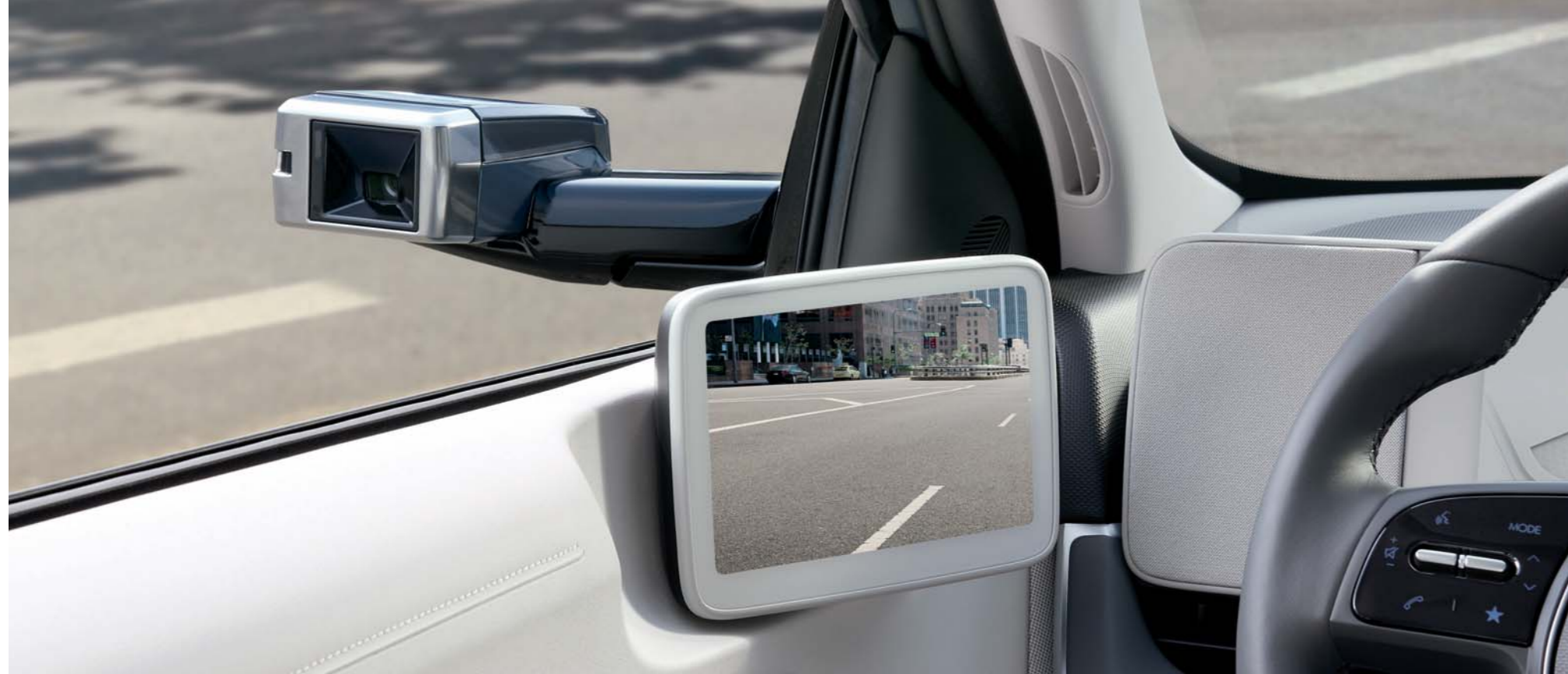
디지털 사이드 미러 (카메라 및 OLED 모니터) 디지털 사이드 미러는 사이드 미러를 카메라와 OLED 모니터로 대체하여 선명한 후방 시야를 제공하며 안전성을 향상시킵니다.
