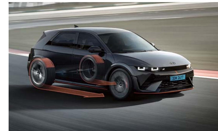
후륜 N 코너 카빙 디퍼렌셜(e-LSD) 구동 바퀴(후륜 좌우 바퀴)에 최적의 모터 출력이 전달되도록 제어해주는 전자식 차동제한 장치로 주행성능을 향상시키고 구동력 손실을 보완합니다.
