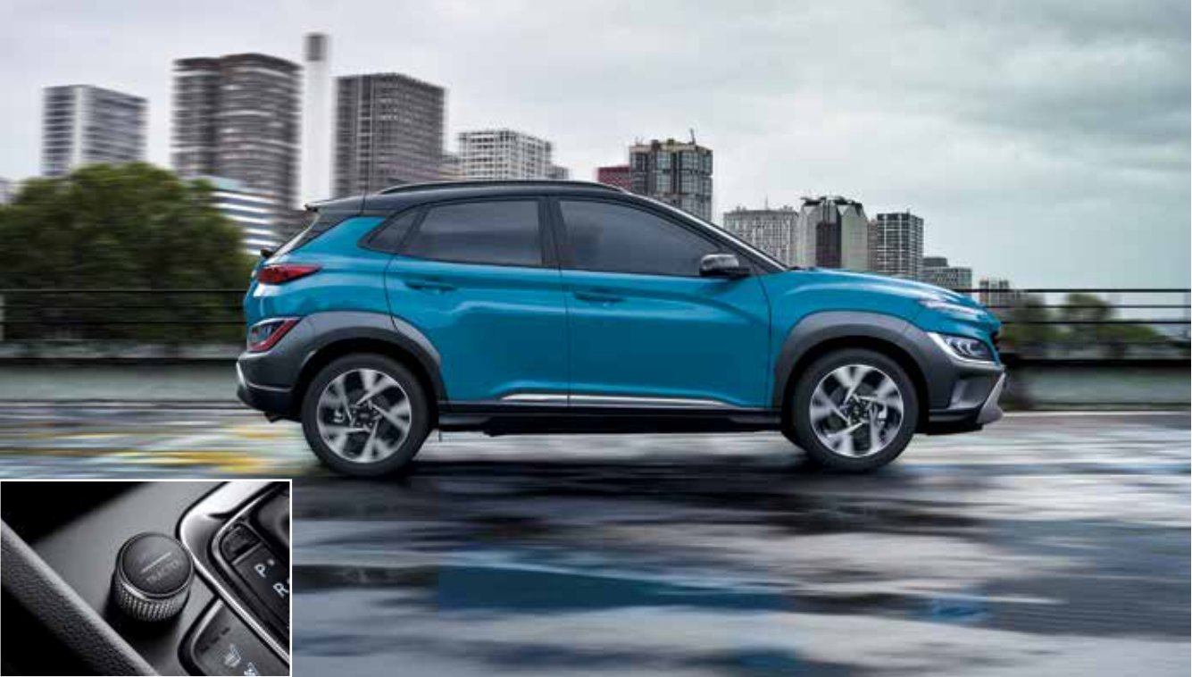
2WD 험로주행모드 2WD 사양에서도 플로어 콘솔 내 트랙션 모드 조그 다이얼을 눌러 2WD 험로주행모드로 설정한 후, 다이얼을 좌/우로 회전 조작하여 SNOW / MUD / SAND의 세부 모드를 선택합니다. 모드 선택에 따라 엔진·제동을 제어하여 노면 조건에 맞춰 최적의 구동 성능을 발휘합니다.
