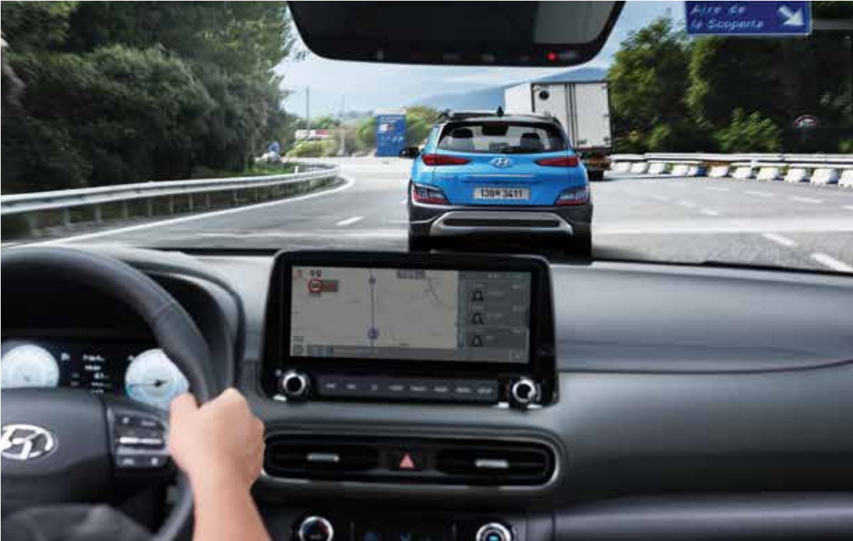
내비게이션 기반 스마트 크루즈 컨트롤 고속도로 주행 시 도로 상황에 맞춰 안전한 속도로 주행하도록 도와줍니다. 안전속도 구간 및 곡선 구간에서는 진입 전에 속도를 자동으로 줄여주고, 이후 안전속도 구간 및 곡선 구간을 통과하면 운전자가 설정한 속도로 복귀합니다.
