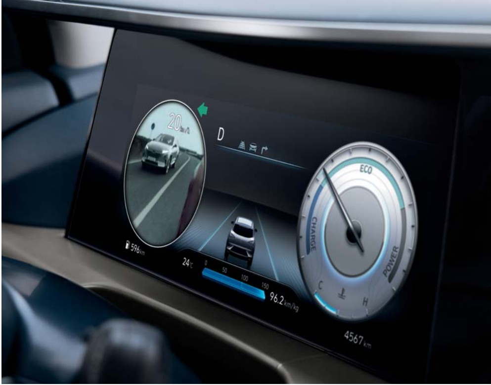
후측방 모니터 안전한 차로 변경을 위해 후측방 상황을 영상으로 보여줍니다. 방향지시등 스위치를 움직이면 해당 방향의 후측방 영상을 표시해줍니다.
