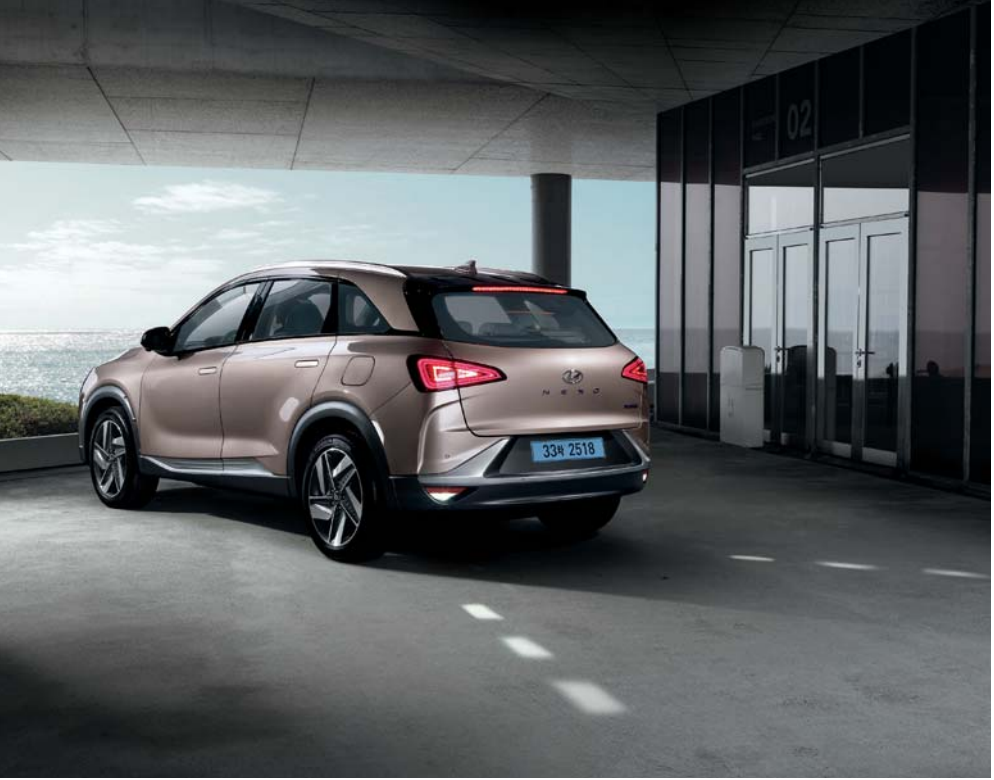
LED 후진 가이드 램프 (세계 최초 적용) 주차 후 후진 출차 시, 후방 노면에 점선 패턴 형상의 가이드라인 조명을 구현함으로써 야간이나 실내공간에서 후진램프 시인성을 높여주어 주위 차량 및 보행자가 NEXO의 후진을 쉽게 인지할 수 있도록 도와줍니다.
