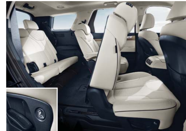
2열 스마트 윈터치 워크인 & 폴딩 2열 시트 상하단에 설치된 워크인 버튼을 누르면 2열 등받이 시트가 전방으로 접히면서 이동하여 3열 좌석 탑승자가 원활하게 승·하차할 수 있도록 도와줍니다.
