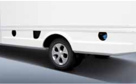
스포일러 빗물받이 우천 시 승객석으로 빗물 유입을 방지합니다. 유틸리티 홀 배터리 점검구, 주유구, 요소수 주입구 설치로 차량 관리가 편리합니다.
