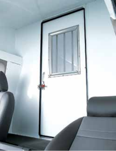
워크스루(610mm X 1,360mm)(선택) 운전석과 실내공간 사이에 도어를 설치하여 이동공간에 확장성을 증대하였습니다.
