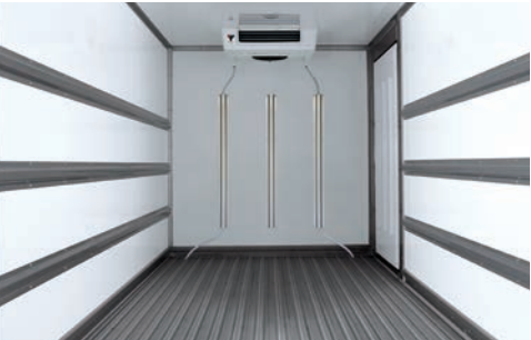
화물실(SUS304 스테인레스) SUS304 재질의 스테인레스를 바닥재로 사용하여 부식 방지 및 보온 효과가 우수합니다.
