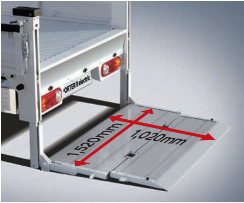
전동유압식 리프트 시스템 (허용하중 : 600kg)
