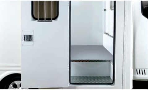
일체형 사이드스텝 차량 내부를 알루미늄 체크판으로 설치되어 실용성을 더했습니다.
