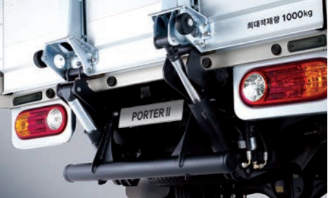
파워게이트 턴인타입 리프트 시스템 (허용하중 : 600kg, 플레이트 중심기준)
