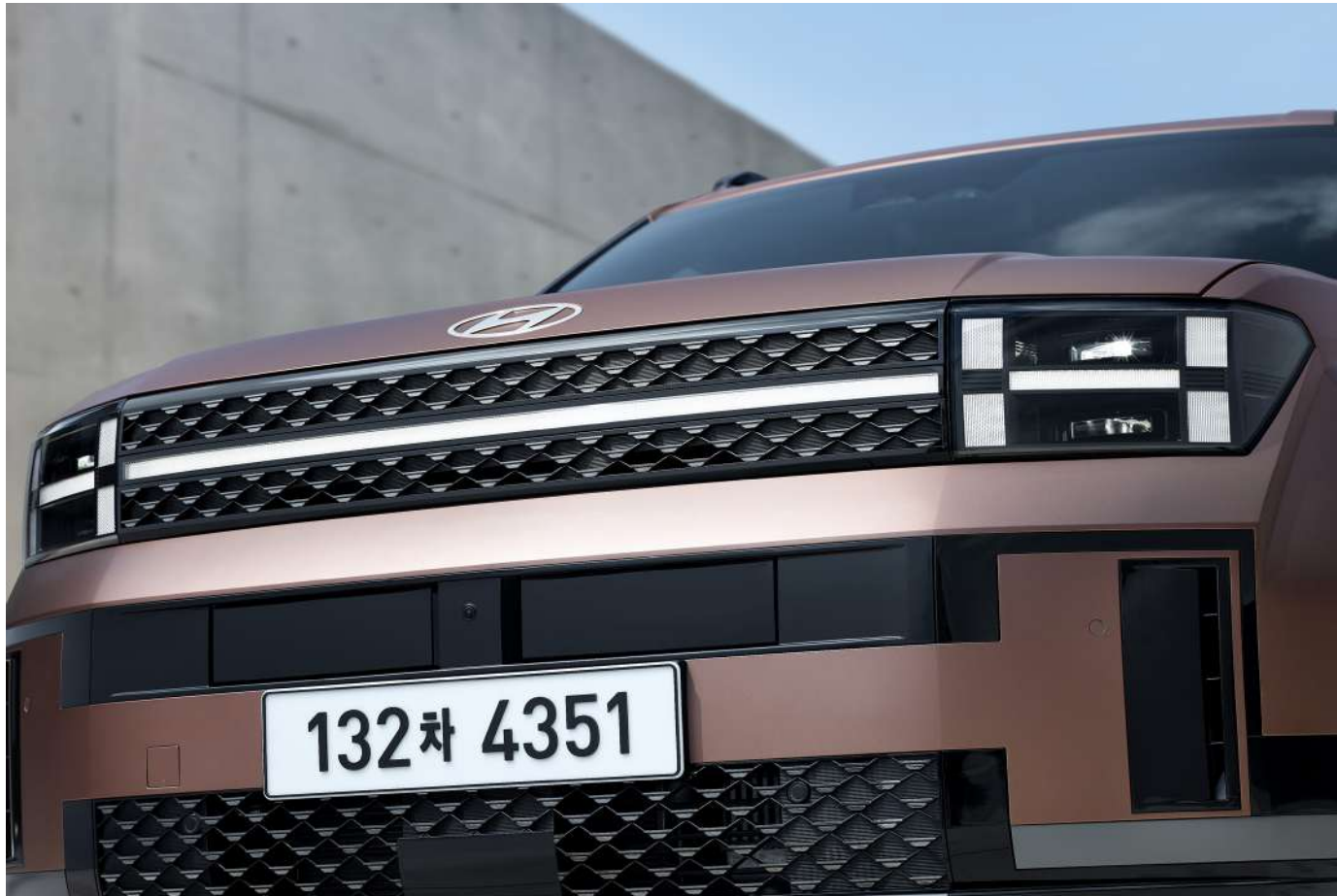
수평형 LED 램프(포지셔닝램프) & Full LED 헤드램프(프로젝션 타입)
