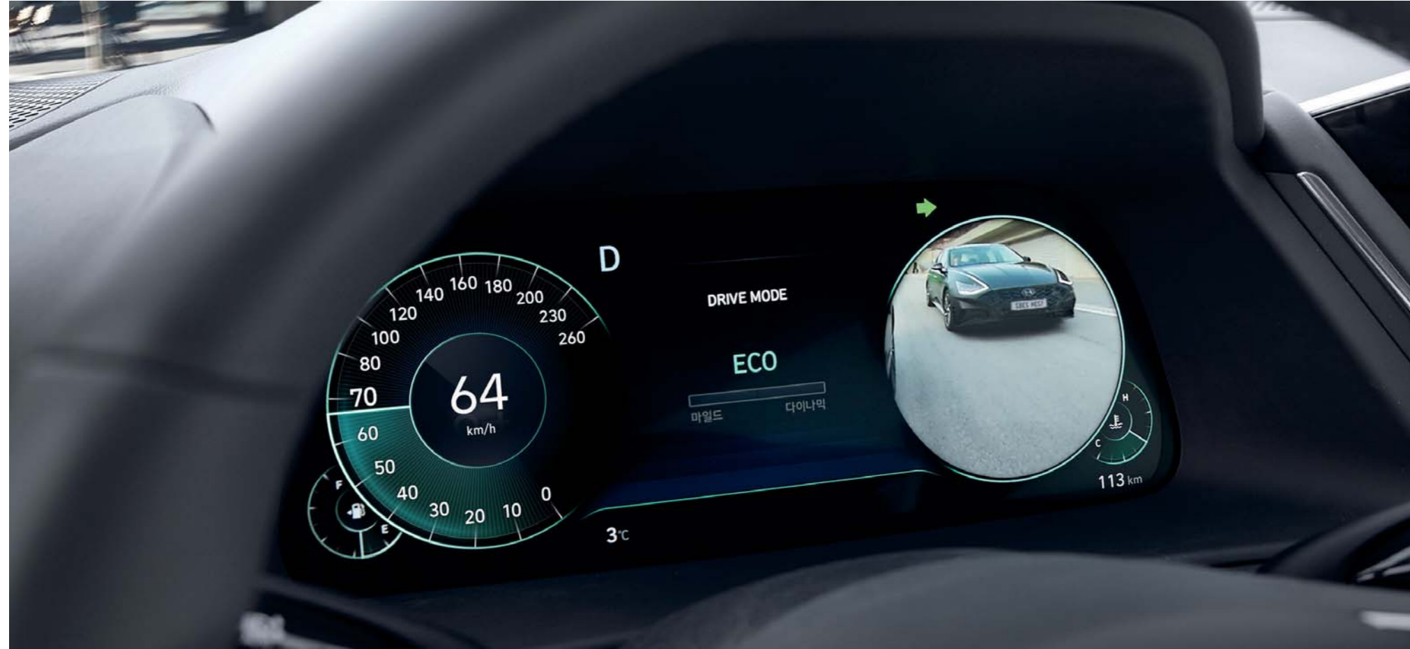
후측방 모니터 방향지시등 점등 시 아웃사이드 미러 하단에 장착된 카메라를 통해 좌 / 우 후측방 영상이 클러스터 화면에 표시됩니다. 우천 시 주행, 사각지대 등 후측방 시야에 제약이 따를 때 선명하고 와이드 한 뷰를 제공하여 보다 안전한 주행을 도와줍니다.
