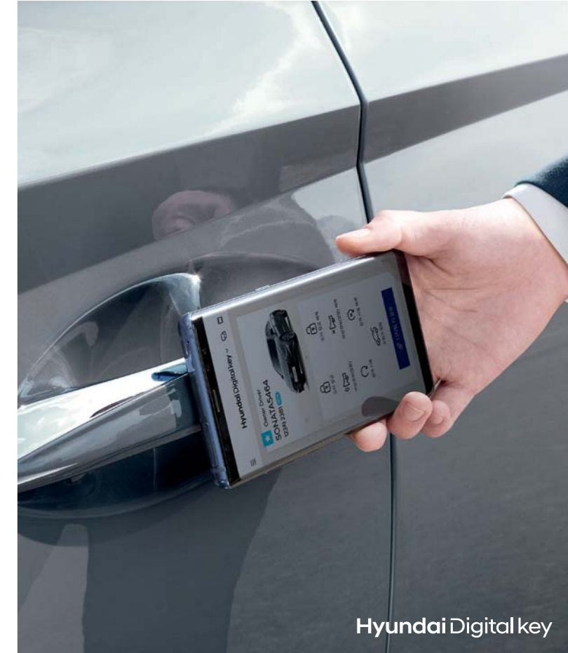
현대 디지털 키 스마트폰으로 차량 외부에서도 도어를 열고 시동을 걸 수 있습니다. 차량을 사용하는 사용자가 누구인지 판단하여 개인화된 서비스를 제공하거나 차량의 사용 권한을 다수의 사람과 공유할 수도 있습니다.
