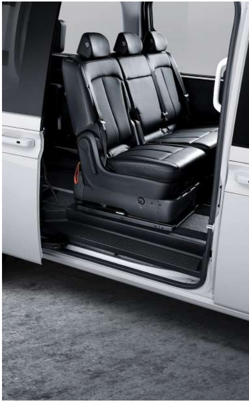
전동 회전시트(선택사양) 유선 리모콘으로 조작하며 몸이 불편한 교통약자의 탑승 및 이동 편의성을 높입니다.
