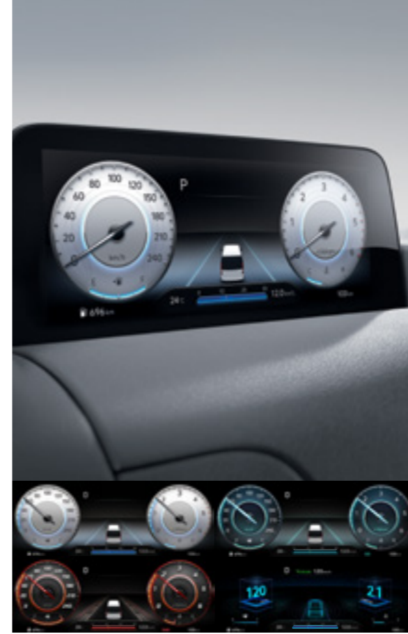
클러스터(10.25인치 컬러 LCD, 오픈형) 시인성을 높인 대화면 LCD와 주행모드별 차별화된 그래픽이 즐거운 드라이빙 경험을 선사합니다.
