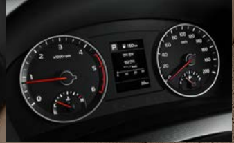
고급형 클러스터 3.5인치 MONO TFT LCD 적용으로 시인성 향상 및 각종 주행 정보를 표시합니다.
