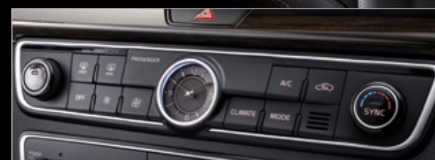
독립제어 풀오토 에어컨 설정한 온도에 맞게 운전석, 동승석의 온도를 각각 다르게 유지할 수 있습니다.
