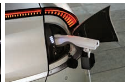
실외 V2L 커넥터 차량 충전구와 연결하여 전자기기를 보다 편리하게 사용할 수 있게 하였습니다.
