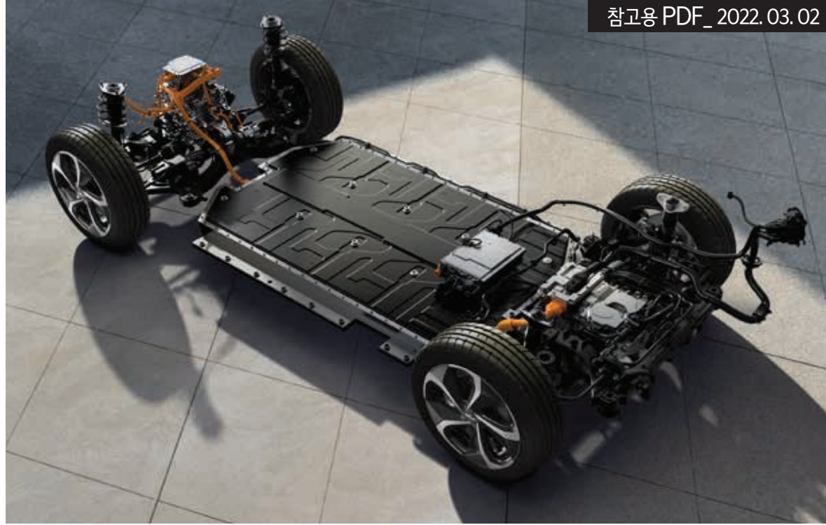
E-GMP 차세대 일체형 PE 시스템을 적용하여 긴 주행거리를 구현하고, 저중심 설계 및 후륜 구동기반으로 뛰어난 주행성능을 제공합니다.
