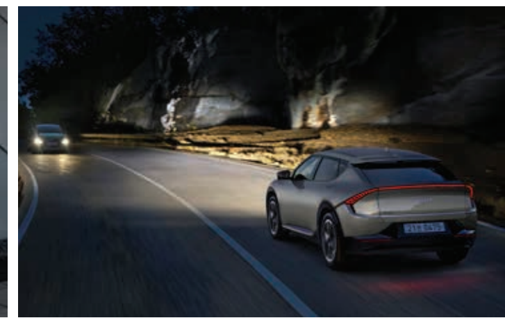
지능형 헤드램프 (IFS) 상향등 상태를 유지하여 운전자의 시야를 안전하게 확보하는 동시에, 마주 오는 전방 차량 영역의 빛을 부분적으로 차단해 대향차 운전자의 눈부심을 막아줍니다. 선행 차량 영역에도 동일하게 작동하며, 별도의 헤드램프 조작 없이도 시야 확보가 유리하기 때문에 야간 운전이 더욱 용이합니다.
