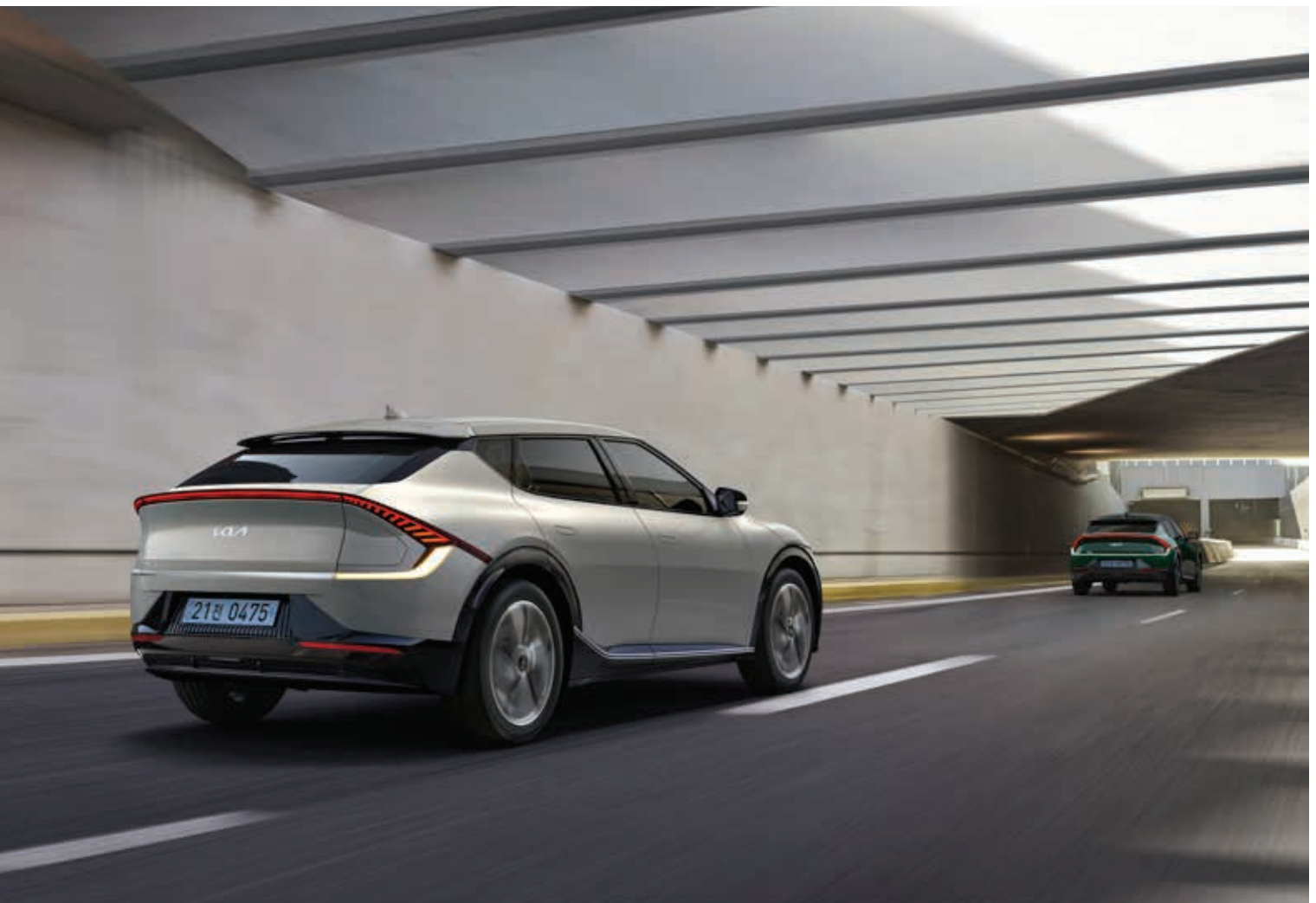
고속도로 주행 보조 2 고속도로 주행 시 앞차와 거리를 유지하며 운전자가 설정한 속도로 곡선로에서도 차로의 중앙을 유지하며 주행하도록 도와줍니다. 또한, 일정 속도 이상으로 주행 시 스티어링 휠을 잡은 상태에서 방향지시등 스위치를 변경하고자 하는 차로 방향으로 움직이면 자동으로 차로를 변경해 줍니다.
