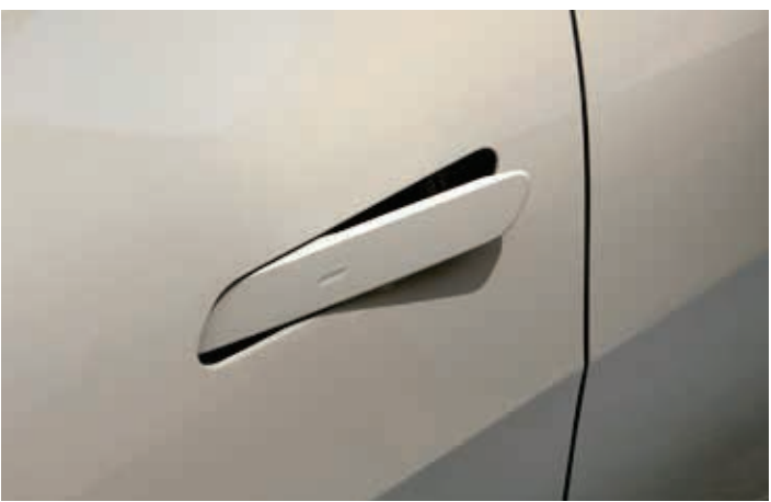
오토 플러시 도어 핸들 주차, 주행 시에는 도어 내측에 숨겨져 있다가 승차차 시 자동으로 팝업되는 오토 플러시 도어 핸들 적용으로 사용 편의성을 증대하고 심리사한 외관을 구현하였습니다.
