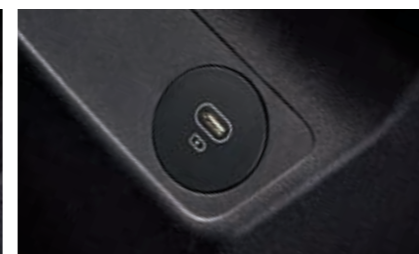
USB C 타입 충전 단자 범용성이 높은 C타입 USB 충전 단자를 적용하여 고속 충전을 지원하고, 충전 편의성을 높였습니다.
