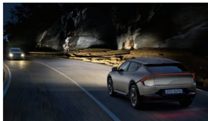
지능형 헤드램프 (IFS) 상향등 상태를 유지하여 운전자의 시야를 안전하게 확보하는 동시에, 마주 오는 전방 차량 영역의 빛을 부분적으로 차단해 대향차 운전자의 눈부심을 막아줍니다. 선행 차량 영역에도 동일하게 작동하며, 별도의 헤드램프 조작 없이도 시야 확보가 유리하기 때문에 야간 운전이 더욱 용이합니다.
