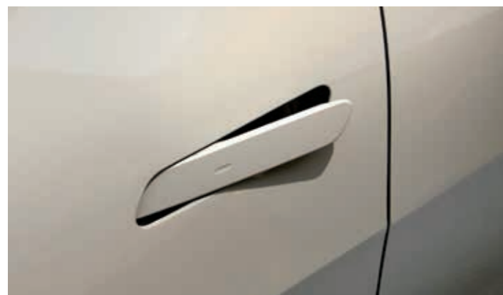
오토 플러시 도어 핸들 주차, 주행 시에는 도어 내측에 숨겨져 있다가 승하차 시 자동으로 팝업되는 오토 플러시 도어 핸들 적용으로 사용 편의성을 증대하고 심리스한 외관을 구현하였습니다.
