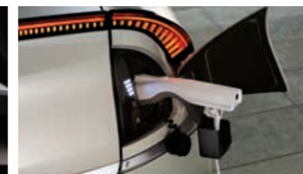
실외 V2L 커넥터 차량 충전구와 연결하여 전자기기를 보다 편리하게 사용할 수 있게 하였습니다.
