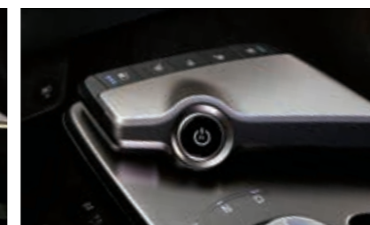
센터 콘솔 버튼식 스위치 시트 열선이나 통풍, 스티어링 휠 열선을 콘솔에서 버튼식으로 조작할 수 있습니다.
