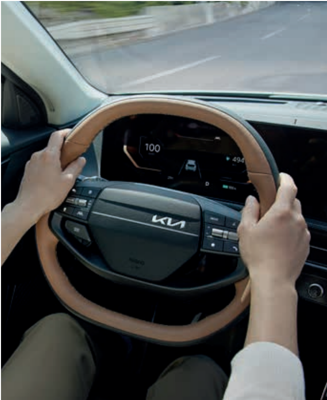
스티어링 휠 그립 감지 운전자가 스티어링 휠에 손만 대고 있어도 Hands-on 상태를 인식하는 정전식 센서가 적용된 스티어링 휠 그립 감지를 통해 더욱 편안한 주행을 경험하실 수 있습니다.
