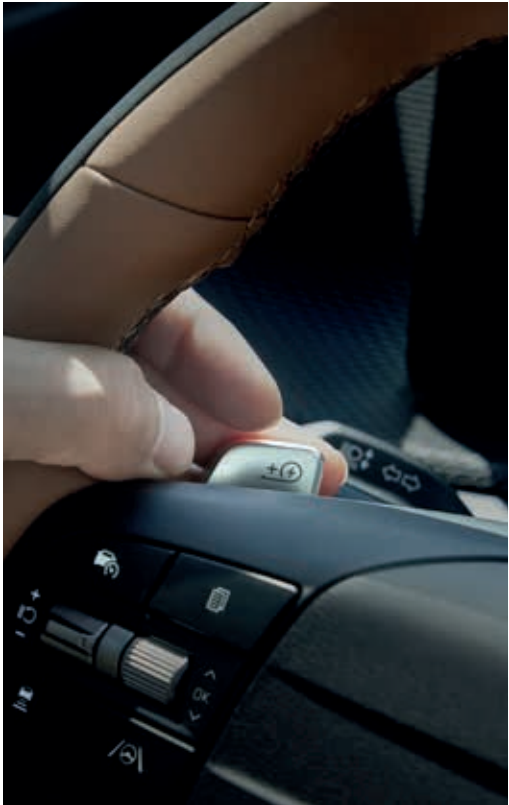
i-PEDAL 모드 가속페달만으로 가속과 감속, 정차까지 가능한 원 페달 모드입니다.
