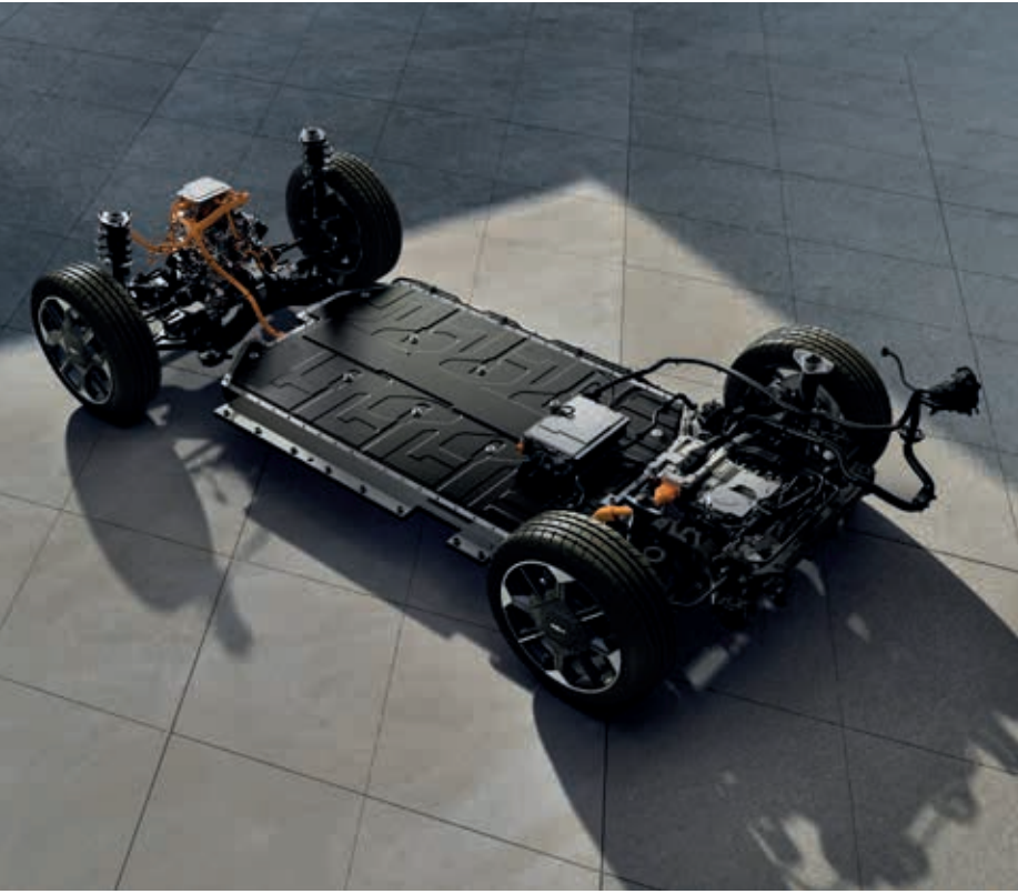
E-GMP 차세대 일체형 PE 시스템을 적용하여 긴 주행거리를 구현하고, 저중심 설계 및 후륜 구동기반으로 뛰어난 주행성능을 제공합니다.
