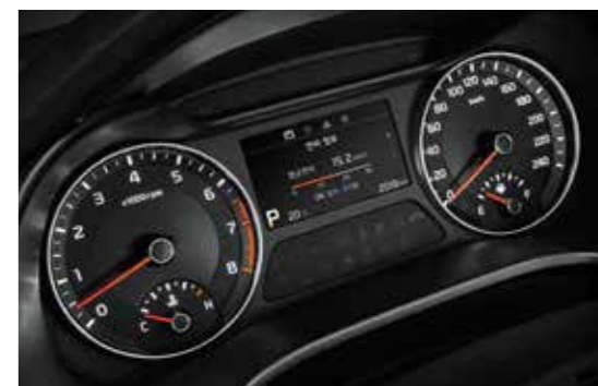
슈퍼비전 클러스터 4.2인치 칼라 TFT LCD 패널을 적용하여 차량 상태 및 다양한 주행 정보를 전달함으로써 안전하고 편리한 운전 환경을 도와 드립니다. ※ 상기 사양구성은 차종, 차급 및 선택 사양에 따라 다르게 적용됩니다.
