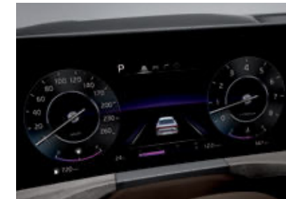
슈퍼비전 클러스터 (12.3인치 칼라 TFT LCD)
