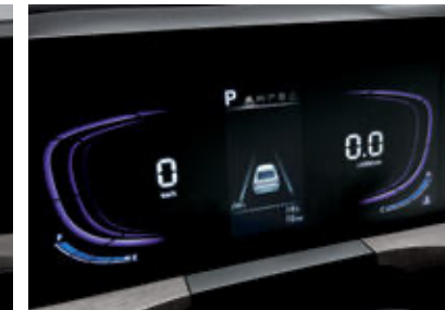
슈퍼비전 클러스터 (4.2인치 칼라 TFT LCD)
