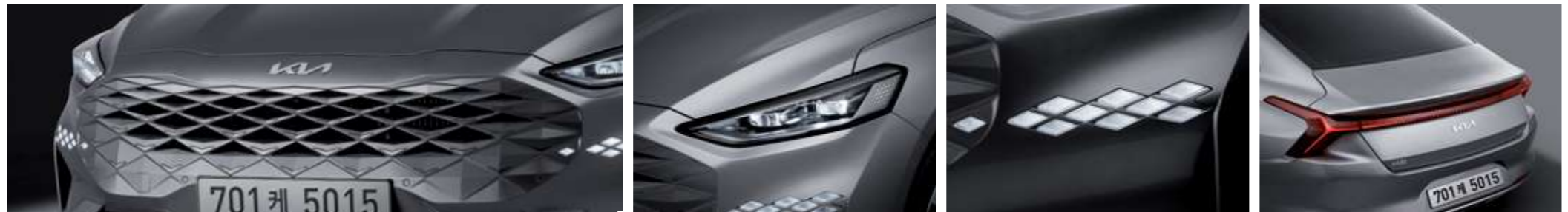
범퍼 일체형 라디에이터 그릴 프로젝션 LED 헤드램프 LED DRL / LED 턴 시그널 LED 리어 콤비네이션램프
