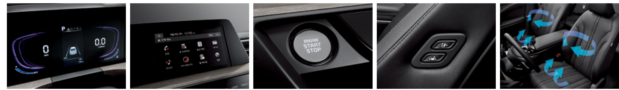
슈퍼비전 클러스터 (4.2인치 칼라 TFT LCD) 8인치 디스플레이 오디오 버튼시동 스마트키 동승석 위크인 디바이스 앞좌석 통풍시트*
