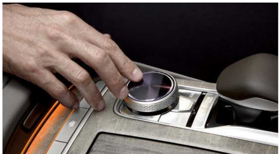
필기인식 통합 컨트롤러
