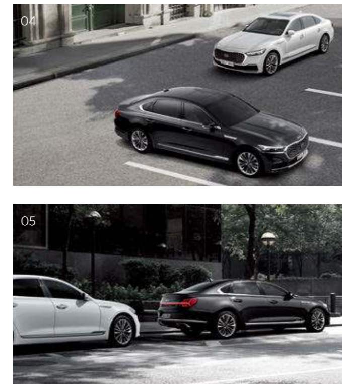
04_ 후방 교차 충돌방지 보조 후진 중 좌/우측에서 다가오는 차량과 충돌 위험이 감지되면 경고를 보냅니다. 경고 후에도 충돌 위험이 높아지면 자동으로 제동을 도와줍니다. 05_ 후방 주차 충돌방지 보조 주차 또는 출차 시 후진 중 보행자 및 장애물과의 충돌이 예상되면 운전자에게 경고하고, 충돌 위험이 높아지면 자동으로 제동을 도와줍니다.
