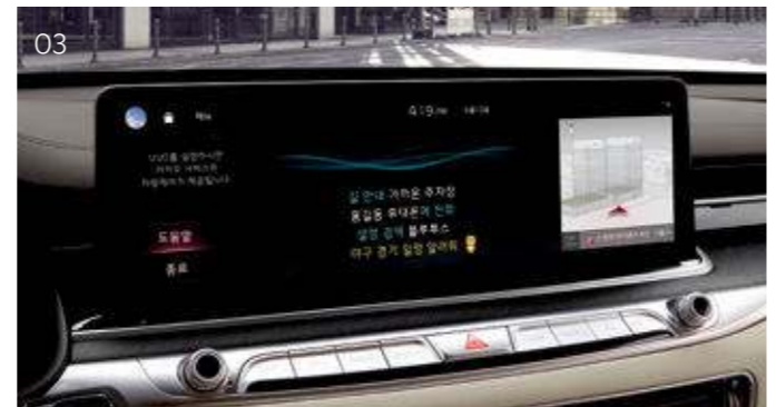
03_ 음성 인식 차량 제어 "에어컨 켜줘"와 같은 직관적인 명령뿐만 아니라 "시원하게 해줘", "따뜻하게 해줘"와 같이 대화하듯 자연스럽게 얘기할 경우에도 그에 맞춰 공조를 제어해주며, 창문 / 스티어링 휠 열선 / 시트 열선 및 통풍 / 뒷유리 열선 등도 음성으로 제어할 수 있는 기능입니다.
