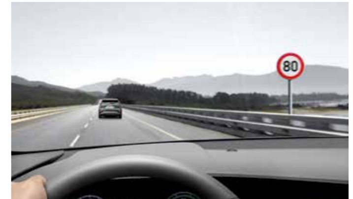
지능형 속도 제한 보조 전방 카메라 또는 내비게이션의 제한 속도 정보를 초과하여 주행할 경우 경고를 해주고 제한 속도를 초과하지 않도록 도와줍니다.
