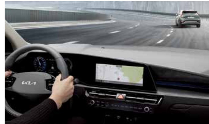
내비게이션 기반 스마트 크루즈 컨트롤 고속도로 / 자동차 전용도로 주행 시 도로 상황에 맞춰 안전한 속도로 주행하도록 도와줍니다. 안전속도 구간과 곡선 구간에서는 진입 전에 속도를 자동으로 줄여주고 이후 안전속도 구간과 곡선 구간을 지나면 원래 설정한 속도로 주행합니다.
