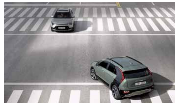
전방 충돌방지 보조 선행 차량이 갑자기 속도를 줄이거나 앞에 정지 차량, 보행자 또는 자전거 탑승자가 나타나는 등 전방 충돌 위험이 감지되면 경고를 해줍니다. 경고 후에도 충돌 위험이 높아지면 자동으로 제동을 도와줍니다. 주행 중 교차로에서 좌회전 시 맞은편에서 다가오는 차량과 충돌 위험이 있다면 자동으로 제동을 도와줍니다.
