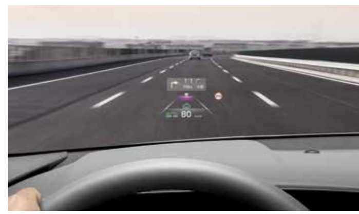
헤드업 디스플레이* 윈드실드 글라스에 입체감 있는 그래픽과 다양한 주행 정보를 투영시켜 보여줌으로써 운전자의 시선 이동을 최소화하여 안전한 운전을 도와드립니다.
