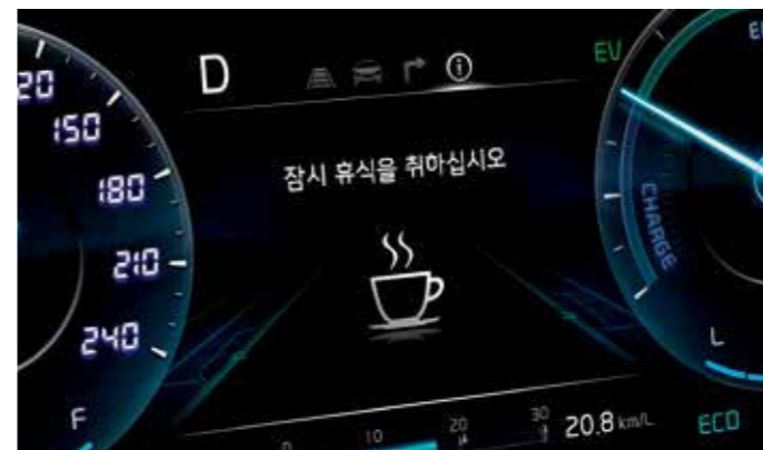
운전자 주의 경고 (전방 차량 출발 알림 기능 포함) 주행 중 운전자 주의 수준이 '나뺌'으로 떨어지면 경고를 해줍니다. 정차 중 전방 차량이 출발하면 운전자에게 알려줍니다.
