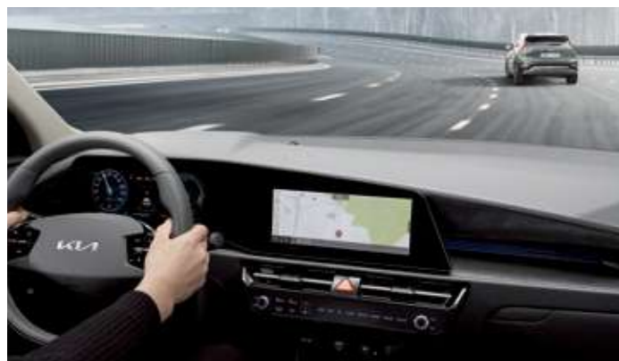
내비게이션 기반 스마트 크루즈 컨트롤 (고속도로/자동차 전용도로 内 안전구간/곡선로) 고속도로 / 자동차 전용도로로 주행 시 도로 상황에 맞춰 안전한 속도로 주행하도록 도와줍니다. 안전속도 구간과 곡선 구간에서는 진입 전에 속도를 자동으로 줄여주고 이후 안전속도 구간과 곡선 구간을 지나면 원래 설정한 속도로 주행합니다.
