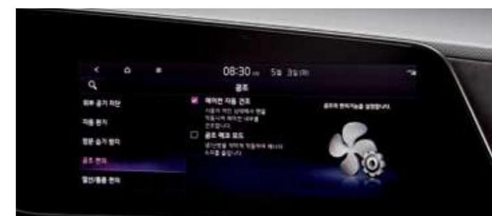
애프터 블로우 ※ EV 전용 에어컨 작동 시 발생하는 응축수를 건조하여 냄새 발생을 사전에 방지하도록 해줍니다.
