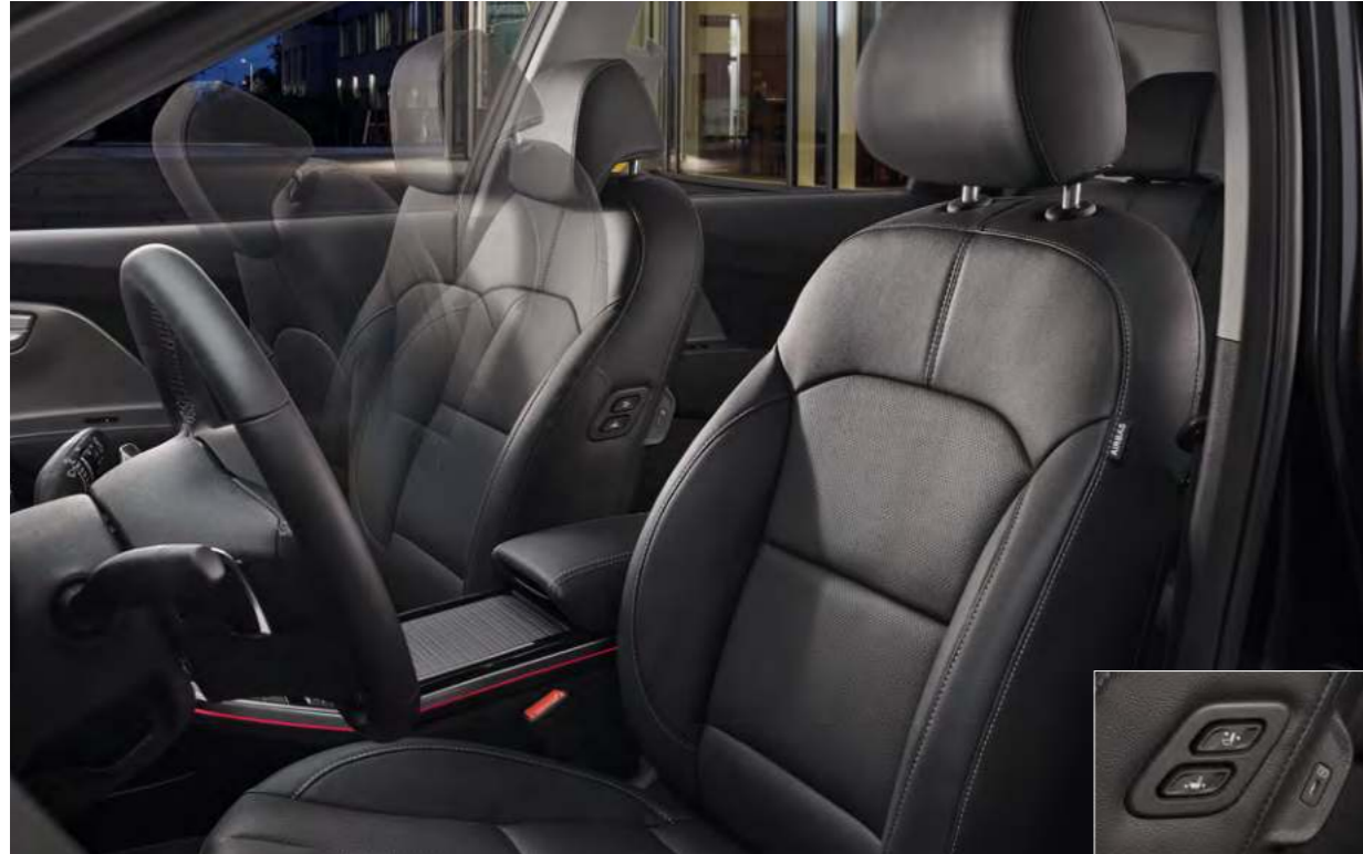
동승석 워크인 디바이스 (택시 모델 限)* 버튼 하나로 동승석 시트 위치와 시트백 각도를 간편하게 조절하여 2열 탑승객의 여유로운 승하차와 공간 활용을 도울 수 있습니다.
