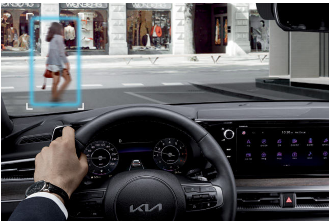
전방 충돌방지 보조 (차량/보행자/자전거 탑승자)* 차량, 보행자, 자전거 탑승자 등 전방 충돌 위험이 감지될 경우 경고를 해주고, 경고 후에도 충돌 위험이 높아지면 자동으로 제동을 도와줍니다.
