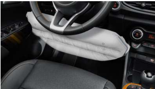
7 에어백 * 운전석, 동승석, 사이드 & 커튼 에어백과 무릎을 보호하는 운전석 무릎 에어백 등 총 7개의 에어백을 적용하였습니다. 운전석 무릎 에어백 *
