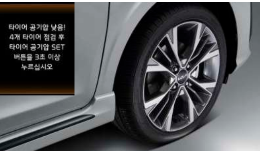
간접식 타이어 공기압 경보 시스템 타이어의 반경과 진동의 변화를 감지하여 설정한 상태보다 공기압이 낮아지면 운전자에게 경고하여 줍니다.
