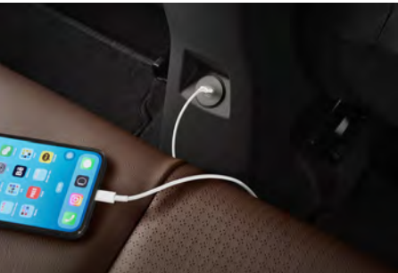
뒷좌석 C타입 USB 단자 (충전용) 슬라이딩 센터 콘솔 암레스트 후면부에 C타입 USB 단자를 적용하여 최신 디바이스와의 호환성을 높였으며, 뒷좌석 탑승객이 편리하게 충전할 수 있도록 하였습니다.
