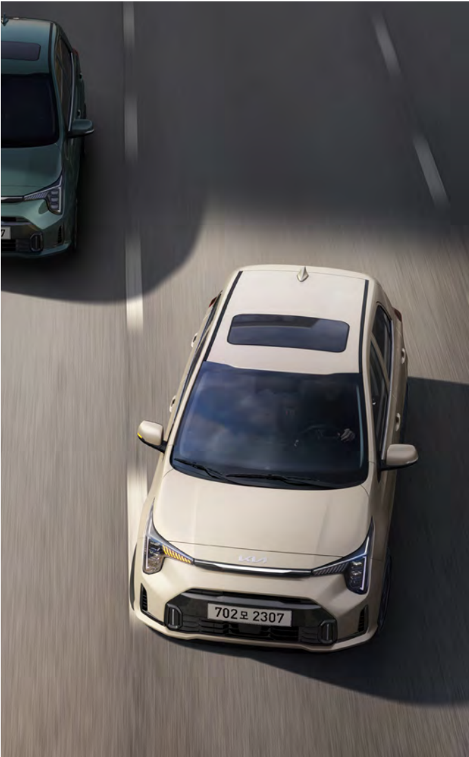
후측방 충돌 경고, 후측방 충돌방지 보조 (전진 출차) 차로 변경 중, 후측방에서 다가오는 차량과 충돌 위험 발생 시 경고를 합니다. 또한 평행 주차상태에서 전진 출차 중, 후측방에서 다가오는 차량과 충돌 위험이 높아지면 자동으로 제동을 도와줍니다.
