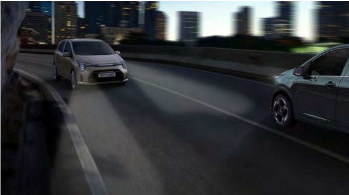
하이빔 보조 맞은편 차량 및 선행 차량의 램프 등 주변 광원 및 조도를 인식해서 자동으로 하이빔을 조절합니다.
