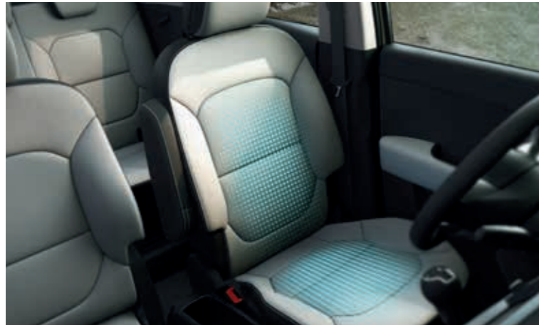
운전석 통풍시트 (Kia Connect 연동)* 시트 내 설치된 통풍 팬으로 바람을 발생시켜 쾌적한 운전 환경을 제공합니다
