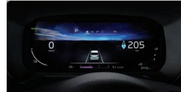
슈퍼비전 클러스터(10.25인치 칼라 TFT LCD)
