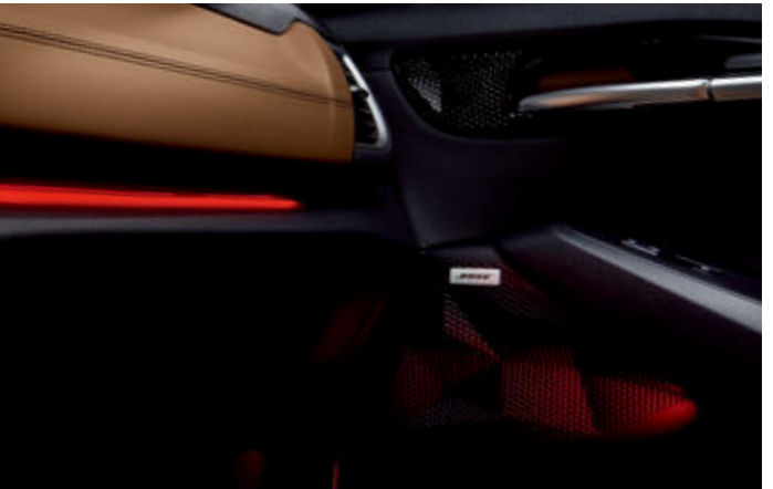
앰비언트 라이트 (사운드 연동 가능) 사운드에 따라 밝기가 변하는 무드 조명을 도어 스피커와 크래쉬 패드 가니쉬에 적용하였습니다.
